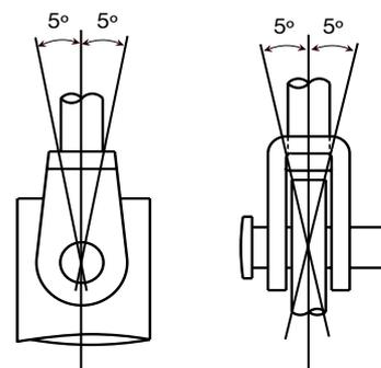
L'angle de débattement minimum entre le ridoir et la cadène doit être de 10° dans toutes les directions
