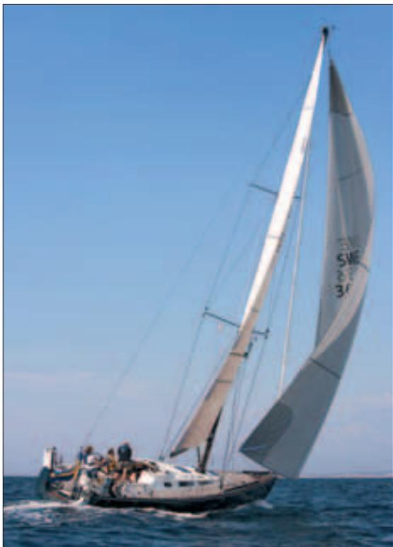
*Le gennaker et le Code 0 se déploient quand il n'est plus possible de conserver le spinnaker. Plus besoin de tangon, de balancine, ni de hale-bas. La navigation au portant devient facile, plus efficace et avant tout plus riche en sensations fortes.*
