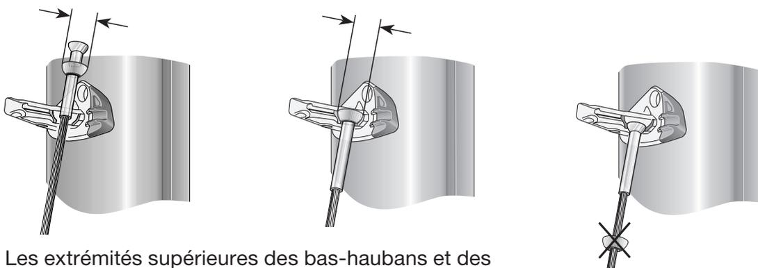
Les extrémités supérieures des bas-haubans et des haubans intermédiaires sont équipées de terminaisons à embouts-boules. Ces terminaisons se fixent sur la ferrure de barre de flèche et leurs tailles peuvent être adaptées en ajoutant une ou deux coupelles.
