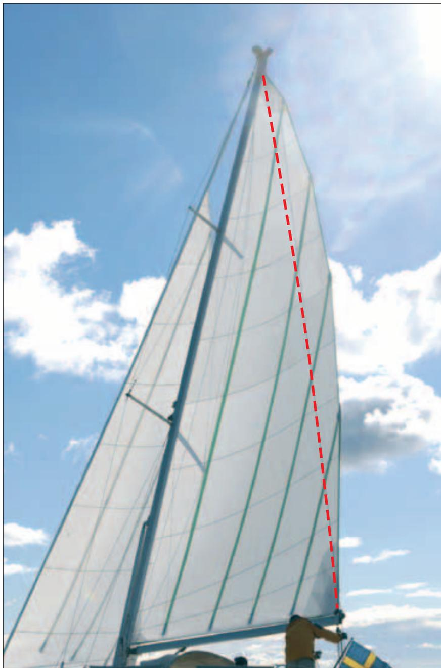
Les mâts enrouleurs Seldén sont conçus pour des voiles avec lattes verticales et rond de chute positif.
