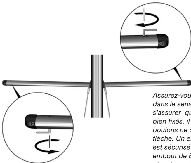
Assurez-vous de bien serrer les boulons de fixation dans le sens des aiguilles d'une montre. Pour s'assurer que les embouts de barres de flèche sont bien fixés, il faut vérifier que la terminaison des boulons ne dépasse pas du profil de la barre de flèche. Un embout de BDF pour gréement continu est sécurisé comme sur le schéma alors qu'un embout de BDF pour gréement discontinu est sécurisé par le dessus, sur bâbord et tribord.
