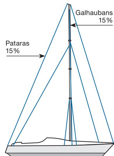
Ce type de gréement possède souvent un étai de trinquette. L'emplacement de cet étai de trinquette détermine si des bastaques sont ou non nécessaires pour assurer la stabilité longitudinale et donner suffisamment de tension à l'étai de trinquette. Nous recommandons d'installer des bastaques si le point d'ancrage de l'étai de trinquette est placé à plus de 6% de la longueur du triangle avant sous l'ancrage de l'étai principal.
